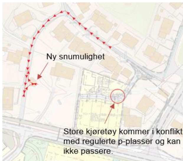
Figur 6-4 Prinsipp for adkomst og snumulighet for store kjøretøy.
