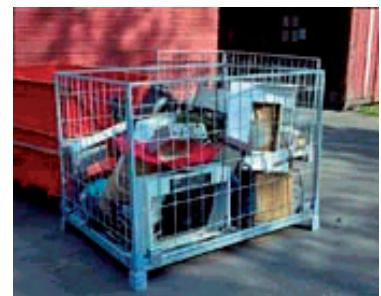
Pallekasse, eigna for oppbevaring av mindre mengder EE-avfall, farleg avfall, metall m.m.
