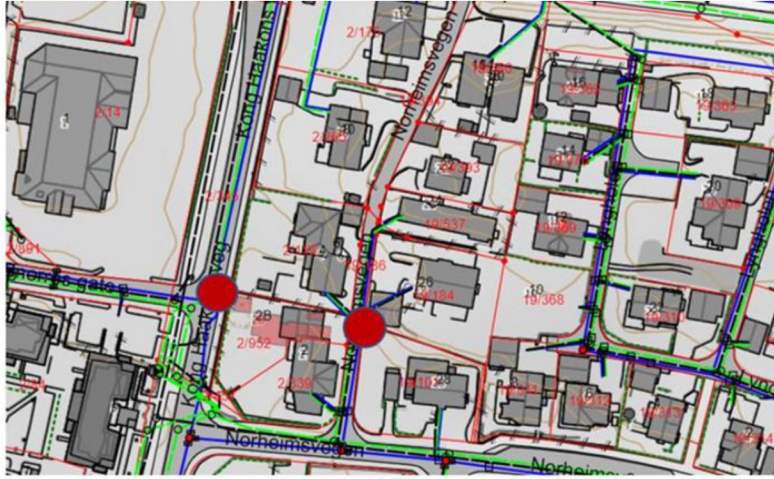
Figur 2 Brannkum iht. kommunekart ivaretar krav til plassering
