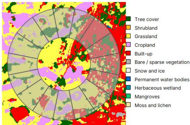
Figur 8: Illustrasjon av landdekke og sektorer for bestemmelse av ruhetslengde for det vertikale hastighetsprofilet og terrenget, Ruhetskart – Archiwind
