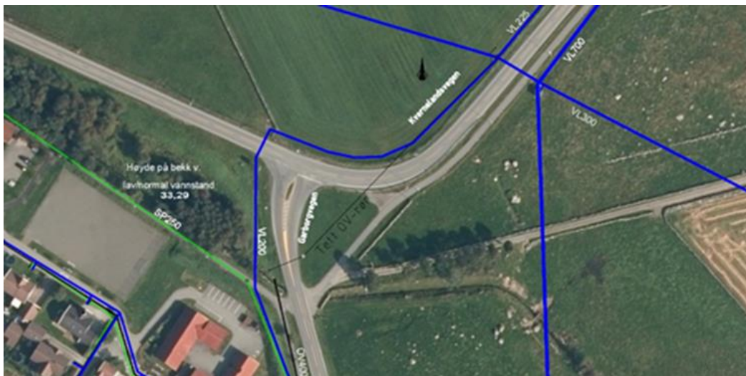
FIGUR 10 INFRASTRUKTUR VANN: VANNLEDNING(BLÅ), OVERVANN(SVART) OG SPILLVANN(GRØN)
