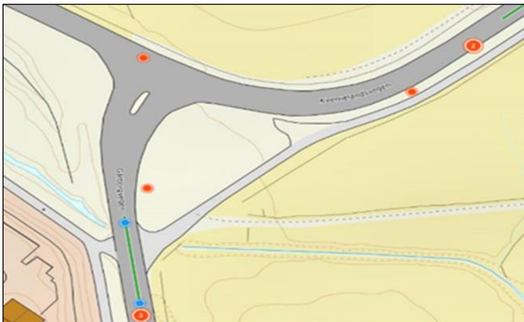
FIGUR 12 SANDFANG(RØD PRIKK), STIKKRENNER(BLÅ) OG DERNSRØYR(GRØN).
