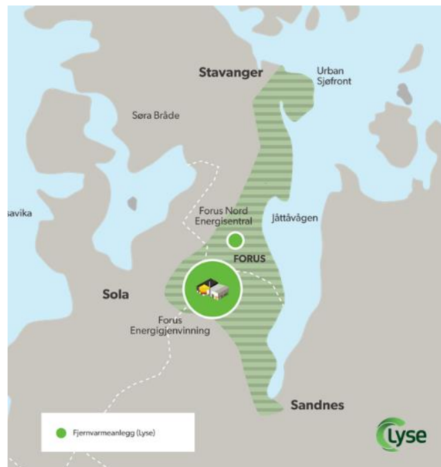
Figur 14 Lyse Neo sitt fjernvarmenett
