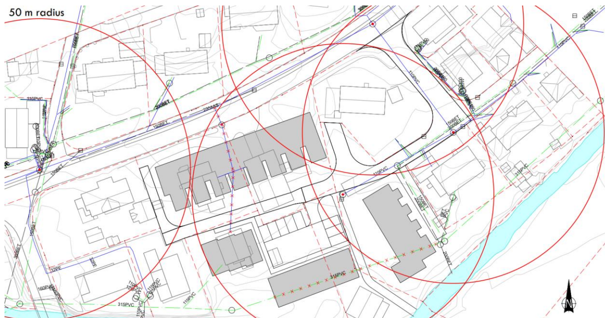
Figur 5 Branndekning i eksisterende kummer.
