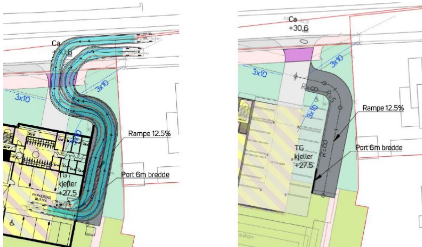
Figur 5 a) Sporing av personbil inn og ut av p-kjeller b) Rampe til p-kjeller, med sikotlinjer c) Plankart
