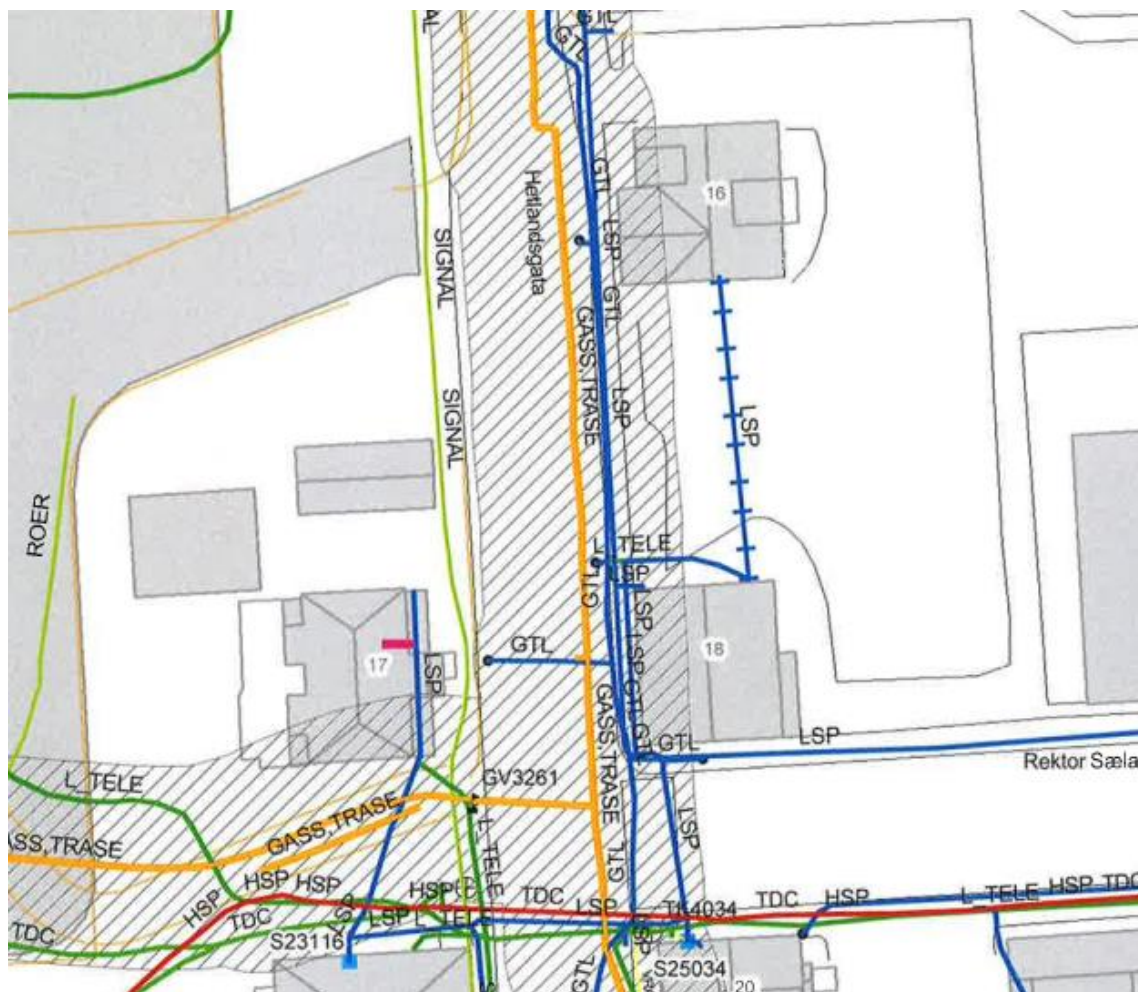
Figur 4 Kart fra Lyse med eksisterende infrastruktur. Gul viser gass og blå viser fjernvarme.
