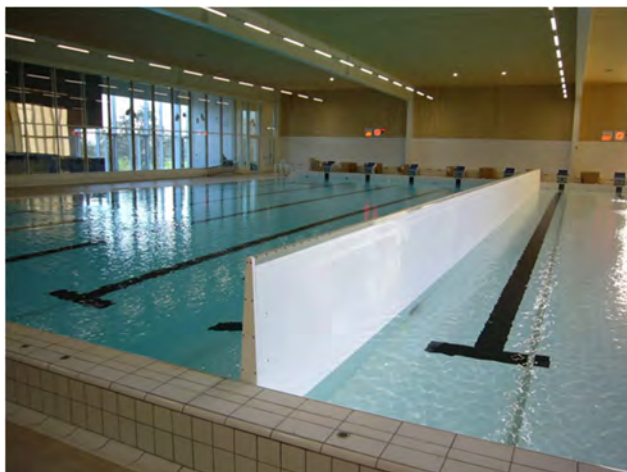
Man kan ha hev og senkbart gulv både på tvers og på langs av bassenget, og man kan stå på det når det er helt oppe.
