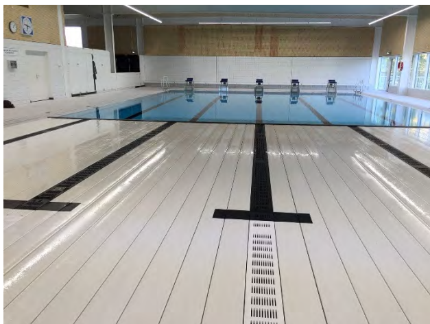
Man kan ha hev og senkbart gulv både på tvers og på langs av bassenget, og man kan stå på det når det er helt oppe.
