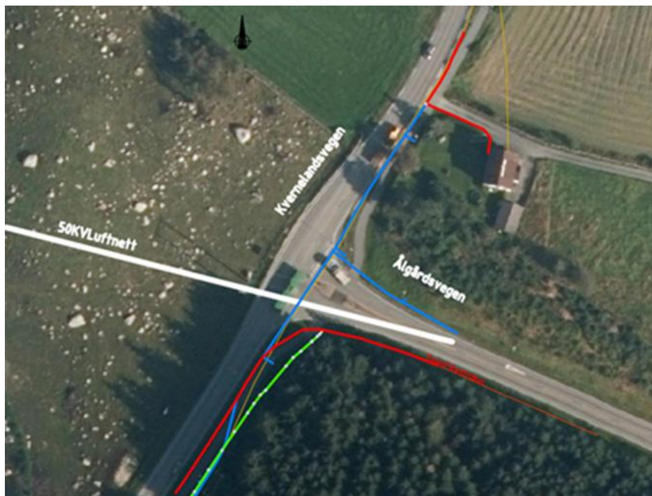
FIGUR 9 LYSE LUFTNETT (KVIT), JORDKABELHSP (RAUD), VEGLYS OG LAVSPENT (BLÅT), TELEFIBER TRASÉ (GRØN), TELIA TELEFIBER TRASÉ (ORANSJE), OG TELENOR(GUL).
