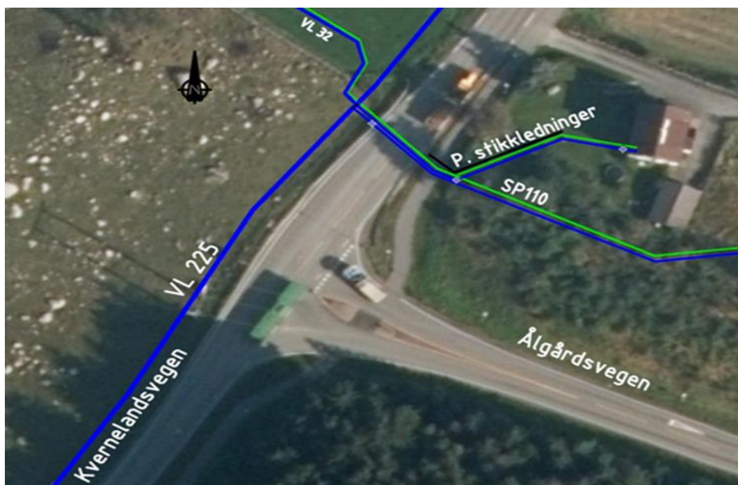
FIGUR 8 VASSLEIDNINGAR(BLÅ), OVERVASSLEIDNINGAR(SVART) OG SPILLVANNSRØR(GRØN).
