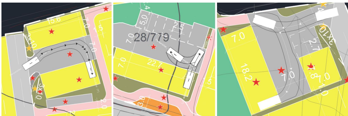
Figur 6-5: Sporingskurver for parkeringsplasser. Figur til venstre viser innkjøring til innerste carport innenfor f_PP1, og midterste figur viser sporing av bil som rygger ut av carport innenfor f_PP2. Det er avsatt like mye snuareal på begge parkeringsplassene slik at snusituasjon vil bli lik. På figur til høyre viser
