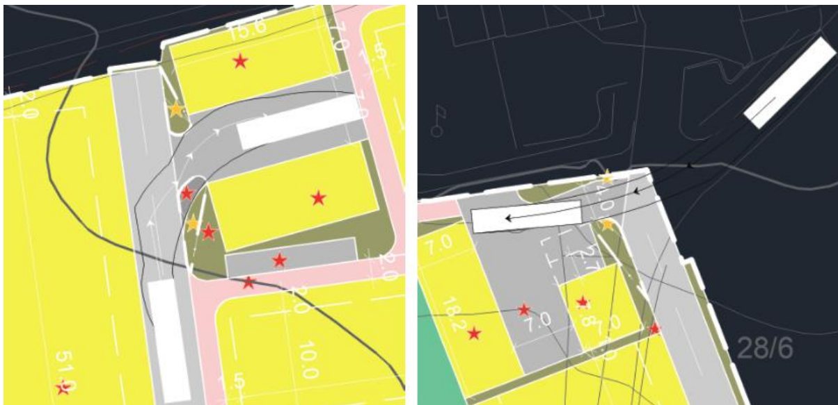
Figur 6-7: Sporingskurver for lastebil type L (inkl. brannbil). Sporingskurve til venstre er ifbm. avkjørsel til f_PP1, og sporingskurve til høyre er ifbm. avkjørsel til f_PP3. Ved sporingskurve til f_PP3 er det vist at brannbil kjører opp tilgrensende adkomstveg til naboeiendom og rygger inn på parkeringsplassen.
