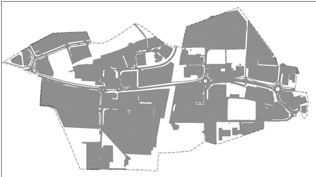
*Figur 16: Oversikt over ikkje-permeable flater*
