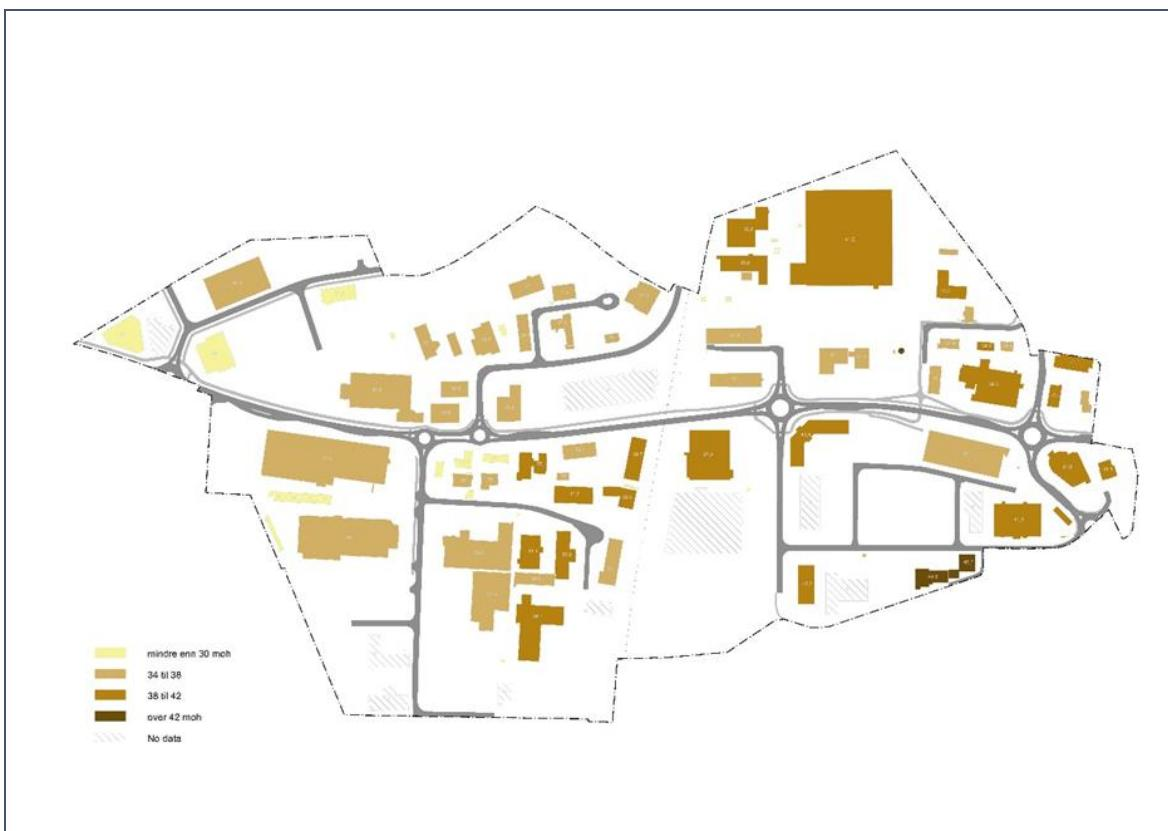
*Figur 11: Eksisterande byggehøgder (i meter over havet)*
