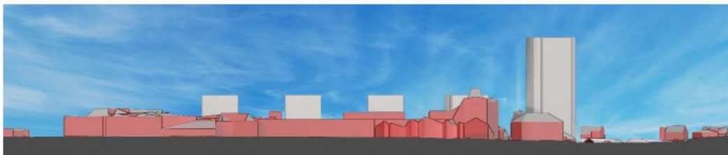
Figur 11 Prinsippnitt av eksisterende bebyggelse vist i rødt, med planlagt plassering av ny bebyggelse vist i hvitt. Prinsippnittet viser planområdet sett fra Bryne sentrum. Det vil i planarbeidet vurderes om det skal legges opp til høyhus i nordlig del av området, innenfor volumet som vises til høyre i prinsippnittet.
