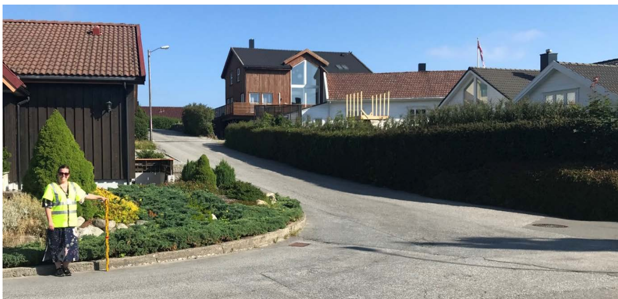
Figur 10 Beplantning i krysset Tverrvegen x Tjødnavegen. Rød strek på målestokk viser nivå for 0,5 meter frisikt.
