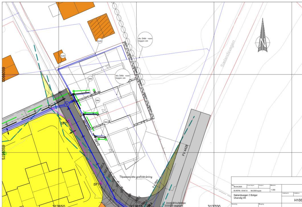
Figur 10 Skisse H100 for utvendig VA-anlegg for de tre boligene innenfor område BKS4.
