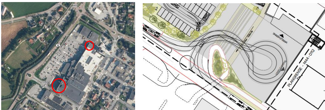
Figur 6.26 Dagens varemottak i planområdet til venstre. Sporing av vogntog i planlagt varemottak sør i planområdet til høyre.
