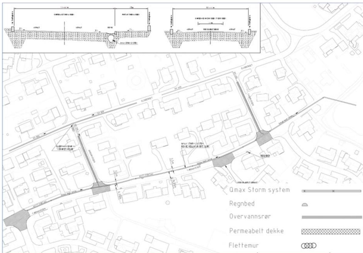
Figur 7.17: Plandokumentene fra ingeniørbyrået IVAR til utførelse av  $Q_{max}$ -Strom-System
