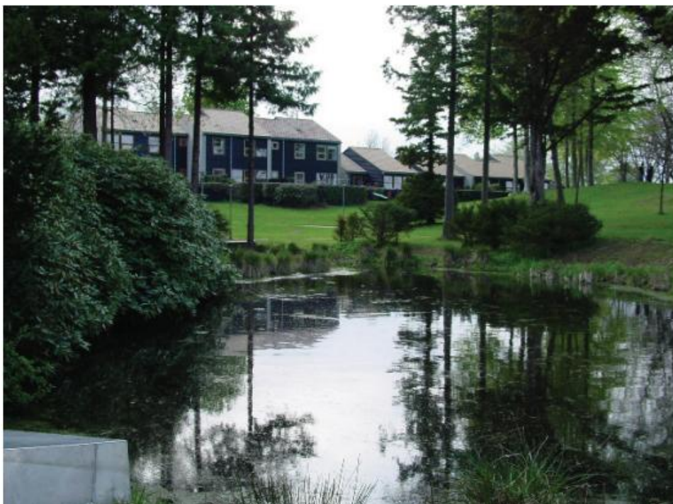
Figur 46: Overvannsdam i boligområde som kombinerer fordrøyning, økologi og landskapselement (Sjølund, København). Foto: Svein Ole Åstebøl (VA Miljøblad, 2007)
