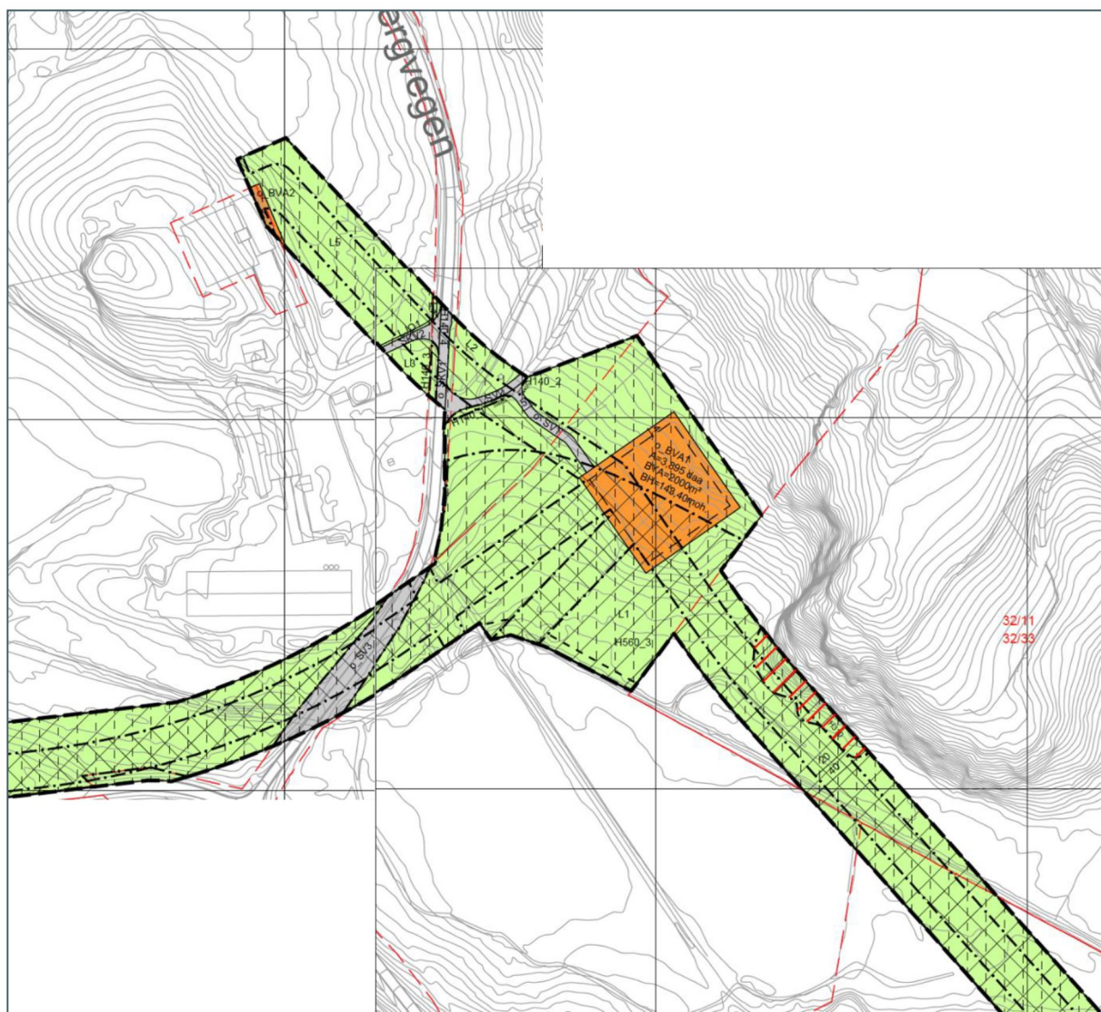
Figur 6-8 Utklipp fra plankart for styringsbasseng ved Fjermestad. Figuren er sammensatt av de to plankartene R002 og R003 på vertikalnivå 2. (Kilde; plankart utarbeidet av COWI AS Time_0504_00_Plankart_Hovedvannledning vest_R002_VN2.pdf og Time_0504_00_Plankart_Hovedvannledning vest_R001_VN2.pdf)
