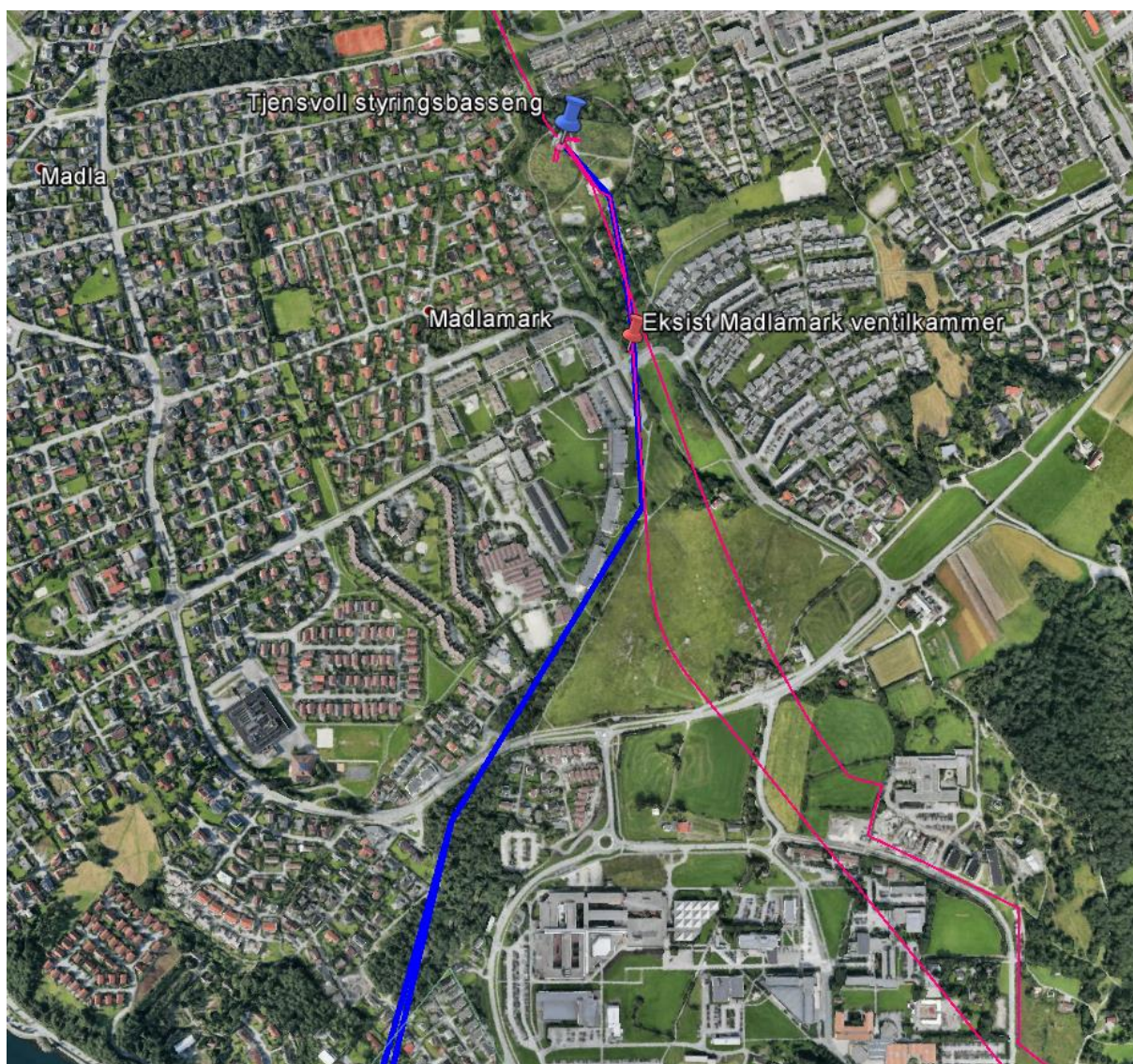
Figur 9 Oversikt ledningstrasé Stavanger kommune. Blå linje er hovedlinje og rosa er eksisterende ledning. Den sørligste delen av traséen over kommunegrensa er foreslått å gå i tunell.
