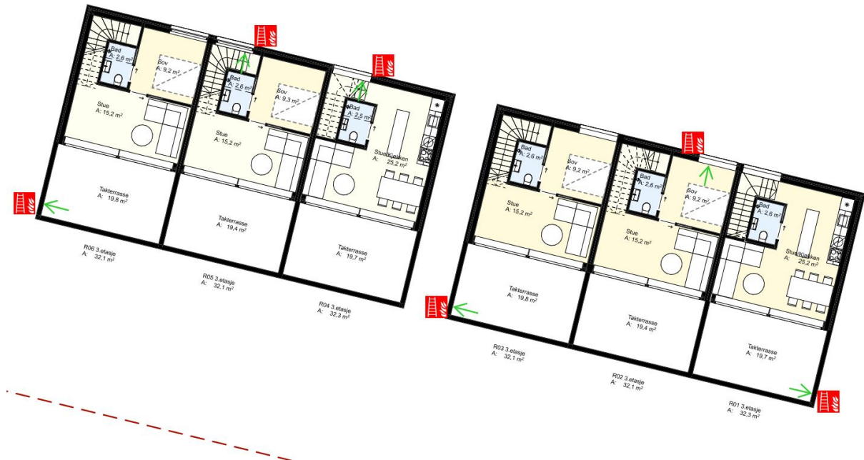
Figur 4 Forslag til plassering av rømningsstiger. OBS: Det er i enkelte av boenhetene ikke mulig å plassere rømningsstiger som ikke passerer vindu eller dører mer enn 2 meter fra vindu i underliggende etasjer. De aktuelle vinduene må derfor ha en brannmotstand på minimum EI 15.
