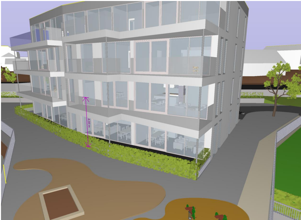
Figur 7 Høyde fra planert terreng til øverste del av rekkverk. Boenheten anses om tilgjengelig for brannvesenet ved bruk av bærbare stiger.
