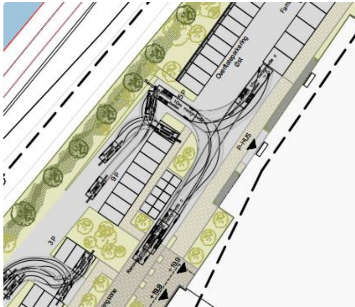
Figur 6 Sporing av renovasjonsbil ved nedgravde containere.
