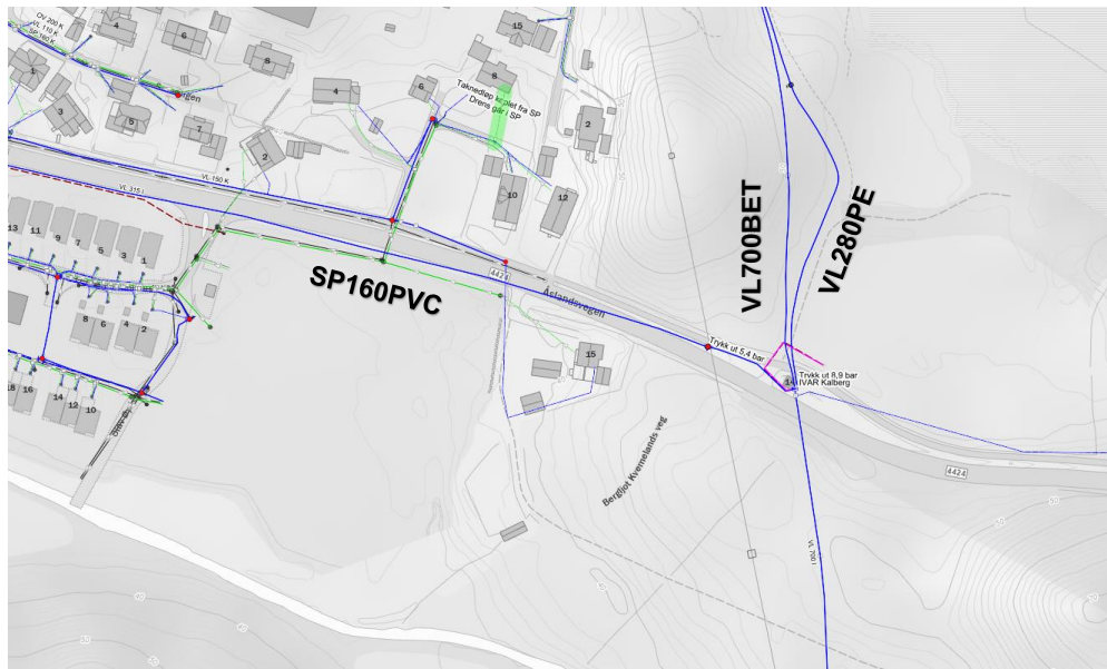
Figur 13 Påkoblingspunkt for vann og spillvann
